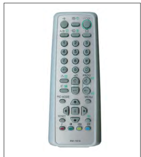
รูปที่ 2-17 รีโมทคอนโทรลอินฟราเรดที่ใช้รหัสข้อมูลของ SONY
